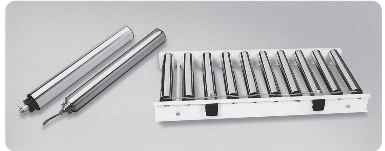
ウエストンローラーを駆動源として、フリーローラーをウレタンVベルトで連結することによって、すべてのローラーを自転させるコンベヤーです。ローラー面との接触度合いにバラツキがある商品でもスムーズに搬送できます。
